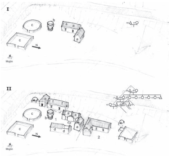
Figura 6. Síntesis de las etapas en el ciclo de construcción de un domicilio. En (I) las casas en L (a), con una cocina circular y el fueguero (b), y los corrales (C). En (II), por un lado, se sumaron nuevas casas (f y d), una nueva cocina techada (e), y las casas originales (a) ya están sin su techo, mochas. A su vez, se construyó un nuevo domicilio (2) con sus propias casas, patio y corrales, correspondiente a una línea colateral. Elaboración propia.
