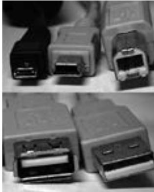
Figura 2.11. Frente de distintos tipos de conectores USB.
